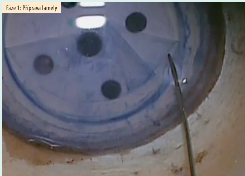
Obr. 1.52 Lamela může prasknout (je tenká)
